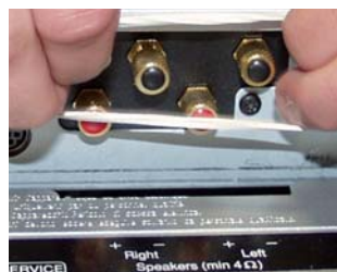
Entfernen der Transportsicherung
