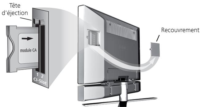
Insérer le module CA avec précaution avec le côté contact vers l'avant dans l'emplacement CI-Slot 1 ou CI-Slot 2.
