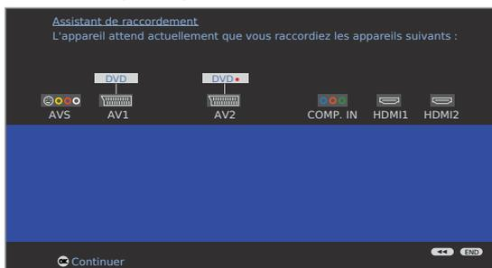
Le plan de raccordement présente les appareils configurés actuellement. Lecteur de DVD sur AV1 et enregistreur de DVD sur AV2 sont les pré-réglages en usine.
