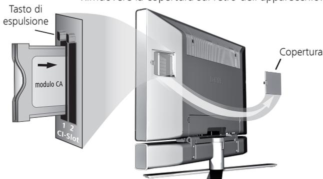
Inserire con attenzione il modulo CA nello Slot CI 1 o 2 con il lato dei contatti rivolto in avanti.
