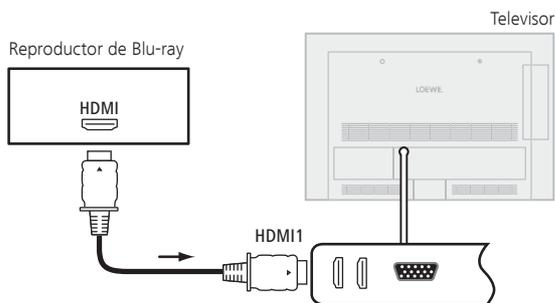
Ejemplo de conexión de un aparato HDMI (p. ej., un reproductor de Blu-ray)
