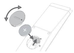
Desenrosque la cubierta del compartimento de pilas en el sentido contrario a las agujas del reloj y retírela. Coloque las pilas del tipo CR2032/DL2032. El polo positivo de la pila debe apuntar hacia arriba. Vuelva a montar la cubierta del compartimento de pilas en el mando a distancia (tenga en cuenta las marcas).
