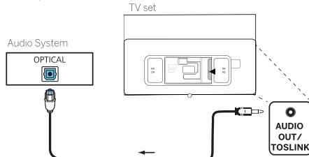
Sluit de audio-uitgang van de tv met het label AUDIO OUT TOSLINK aan op de digitale audio-ingang van een audiosysteem.
