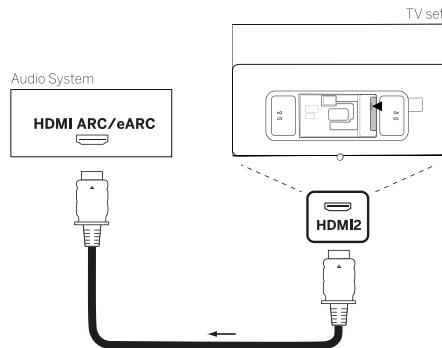
Benutzen Sie ein HDMI-Kabel (nicht im Lieferumfang enthalten), um die HDMI-eARC-Buchse des Fernsehgeräts mit der HDMI-ARC/eARC-Buchse eines Audiosystems oder einer Soundbar zu verbinden. Wir empfehlen, dass Sie ein als „Ultra-High-Speed-HDMI-Kabel“ gekennzeichnetes Kabel mit einem Typ-A-Stecker verwenden.
