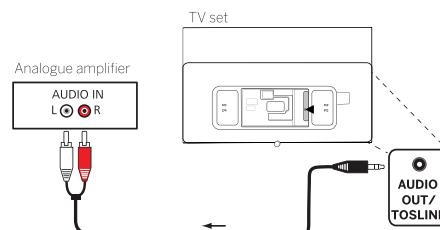
Gebruik een stereo cinch-connector/adapterkabel om de audio-uitgang AUDIO OUT TOSLINK aan te sluiten op de analoge audio-ingang van het audiosysteem.
