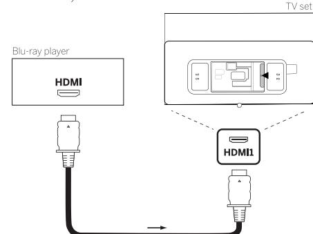
Connectez l'appareil à l'aide d'un câble HDMI avec un connecteur de type A (non fourni) à l'une des prises HDMI du téléviseur. Pour profiter pleinement des capacités de votre téléviseur, utilisez un câble étiqueté « Câble HDMI Premium High-Speed » ou mieux.
