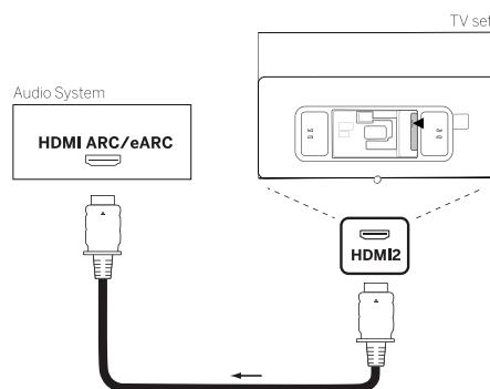
Utilisez un câble HDMI (non fourni) pour connecter la prise HDMI eARC du téléviseur à la prise HDMI ARC/eARC d'un système audio ou d'une barre de son. Il est recommandé d'utiliser un câble marqué « Câble HDMI Ultra High-Speed » avec un connecteur de type A.
