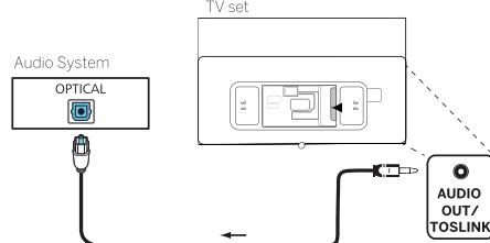
Conecte la salida de audio del televisor etiquetada como AUDIO OUT TOSLINK a la entrada de audio del sistema de audio.
