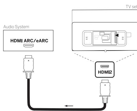
Usa un cavo HDMI (non fornito) per connettere una presa HDMI eARC del televisore alla presa HDMI ARC/eARC di un sistema audio o una soundbar. Si consiglia di usare un cavo denominato "Cavo HDMI a velocità ultra alta" con un connettore di Tipo A.
