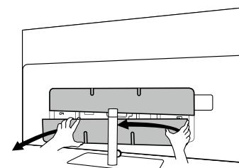
Quando si connettono dispositivi esterni a questi connettori interni, prima connetti il cavo al connettore sul televisore. Poi fai passare il cavo all'esterno del televisore utilizzando il sistema di gestione dei cavi integrato, e quindi fai passare il cavo attraverso il collo del supporto (nel caso in cui utilizzi la soluzione di supporto da tavolo fornita).
