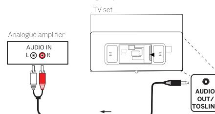
Utilisez un câble adaptateur stéréo pour connecter la sortie audio AUDIO OUT TOSLINK à l'entrée audio analogique du système audio.
