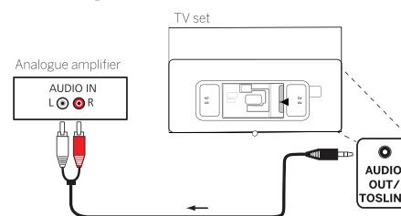
Verbinden Sie den Audioausgang „AUDIO OUT TOSLINK“ über ein Stereo-Cinch/Klinken-Adapterkabel mit dem analogen Audioeingang der Audioanlage.
