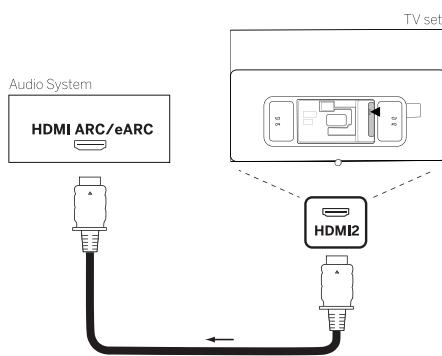
Gebruik een HDMI-kabel (niet meegeleverd) om de HDMI eARC-aansluiting van de tv te verbinden met de HDMI ARC/eARC-aansluiting van een audiosysteem of soundbar. We raden aan om een kabel te gebruiken met de aanduiding "Ultra High-Speed HDMI Cable" en een type A connector.
