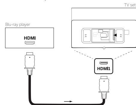
Ligue o dispositivo através de um cabo HDMI com um conector de tipo A (não fornecido) a uma das tomadas HDMI do televisor. Para desfrutar totalmente das capacidades do seu televisor, use um cabo com a etiqueta "Cabo HDMI de alta velocidade premium" ou melhor.
