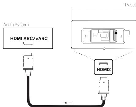
Use un cable HDMI (no suministrado) para conectar la toma HDMI eARC del televisor a la toma HDMI ARC/eARC de un sistema de audio o barra de sonido. Se recomienda utilizar el cable marcado como "Ultra High-Speed HDMI Cable" con un conector de tipo A.
