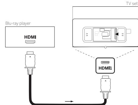
Sluit het apparaat via een HDMI-kabel met een type A-connector (niet meegeleverd) aan op één van de HDMI-aansluitingen van het TV-toestel. Om de mogelijkheden van uw tv optimaal te benutten, gebruik u een kabel met het label "Premium High-Speed HDMI Cable" of beter.
