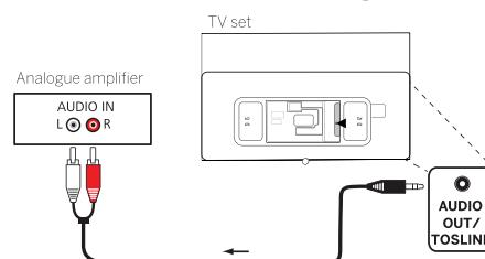
Utilice un adaptador/conector estéreo para conectar la salida de audio AUDIO OUT TOSLINK a la entrada de audio analógica del sistema de audio.
