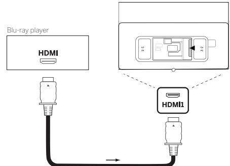
Conecte el dispositivo con un cable HDMI con conector de tipo A (no suministrado) a una de las tomas HDMI del televisor. Para disfrutar de las funciones de su televisor, utilice un cable de tipo Premium High-Speed HDMI o superior.
