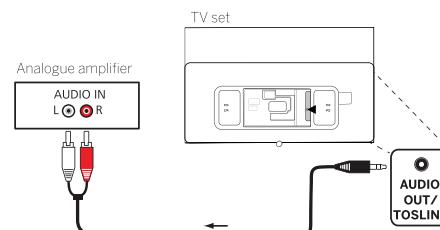
Usa un cavo adattatore jack stereo per connettere l'uscita audio 'AUDIO OUT TOSLINK' all'ingresso audio analogico del sistema audio.
