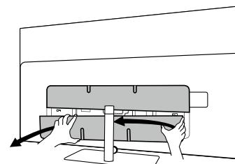
Al conectar dispositivos externos a estos conectores internos, conecte primero el cable al conector del televisor. A continuación, extraiga el cable del televisor utilizando el sistema integrado de gestión del cable e insértelo a través del cuello del soporte (en caso de que utilice la solución de soporte de mesa).
