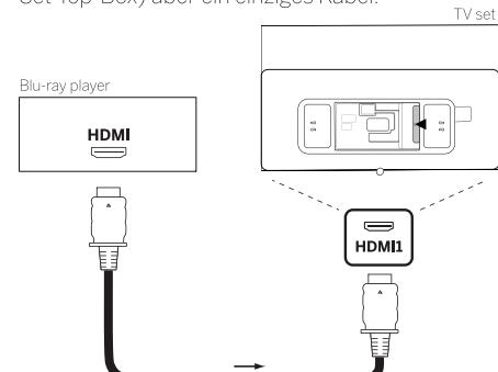
Verbinden Sie das Gerät über ein HDMI-Kabel mit einem Typ-A-Anschluss (nicht im Lieferumfang enthalten) mit einem der HDMI-Anschlüsse des Fernsehgeräts. Um die Funktionen Ihres Fernsehers voll auszuschöpfen, benutzen Sie ein Kabel mit der Kennzeichnung „Premium High-Speed HDMI-Kabel“ oder besser.
