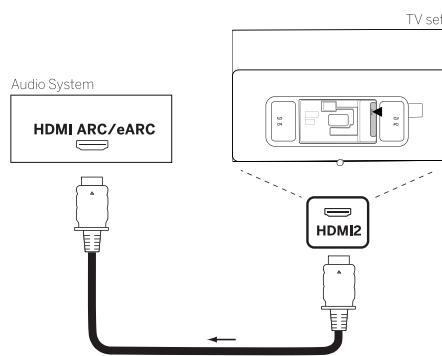
Use um cabo HDMI (não fornecido) para ligar a tomada HDMI eARC do televisor à tomada HDMI ARC/eARC de um sistema de áudio ou da barra de som. Recomenda-se a utilização de um cabo marcado como "Cabo HDMI ultra de alta velocidade" com um conector de tipo A.
