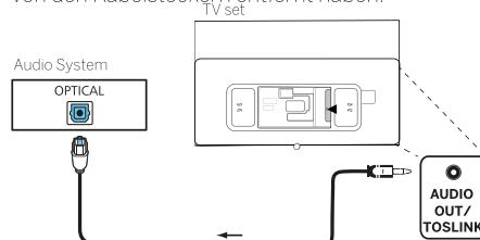
Verbinden Sie den Audioausgang des Fernsehgeräts mit der Bezeichnung „AUDIO OUT TOSLINK“ mit dem digitalen Audioeingang eines Audiosystems.
