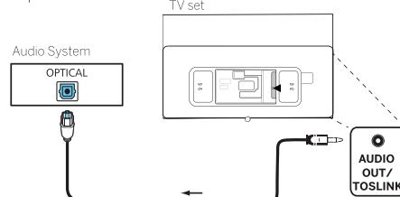
Connectez la sortie audio du téléviseur étiquetée AUDIO OUT TOSLINK à l'entrée audio numérique d'un système audio.
