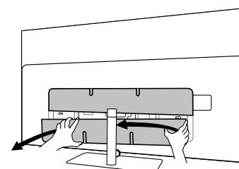
Wenn Sie ein externes Gerät mit diesen internen Anschläßen verbinden, schließen Sie das Kabel zuerst an den Anschluss am Fernsehgerät an. Führen Sie das Kabel dann über das integrierte Kabelführungssystem aus dem Fernsehgerät heraus und führen Sie es dann durch den Hals des Standfußes (falls Sie die mitgelieferte Tischfußlösung verwenden).
