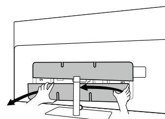
Als u externe apparaten op deze interne aansluitingen aansluit, moet u eerst de kabel op de aansluiting van de tv aansluiten. Leid de kabel vervolgens uit de tv met behulp van de ingebouwde kabelgeleiding. Leid de kabel vervolgens door de hals van de standaard (als u de meegeleverde tafelstandaard gebruikt).
