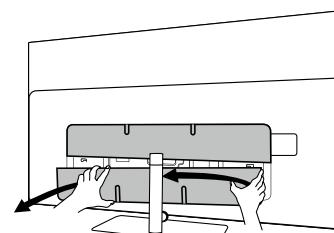
Quando ligar dispositivos externos a estes conectores internos, ligue primeiro o cabo ao conector do televisor. Depois conduza o cabo para fora do televisor através do sistema de gestão de cabos incorporado e leve-o pelo pescoço do suporte (caso use o sistema de suporte de mesa fornecido).
