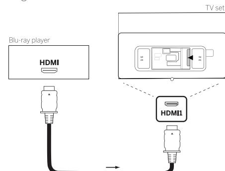
Connetti il dispositivo tramite cavo HDMI con un connettore di Tipo A (non fornito) a una delle prese HDMI del televisore. Per godere di tutte le funzionalità del tuo televisore, usa un cavo denominato "Cavo HDMI ad alta velocità premium" o migliore.
