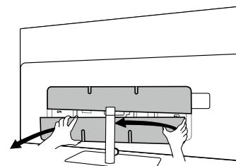
Lorsque vous connectez des appareils externes à ces connecteurs internes, connectez d'abord le câble au connecteur du téléviseur. Acheminez ensuite le câble hors du téléviseur à l'aide du système de gestion des câbles intégré, puis faites passer le câble à travers le col du support (si vous utilisez la solution de support de table fournie).
