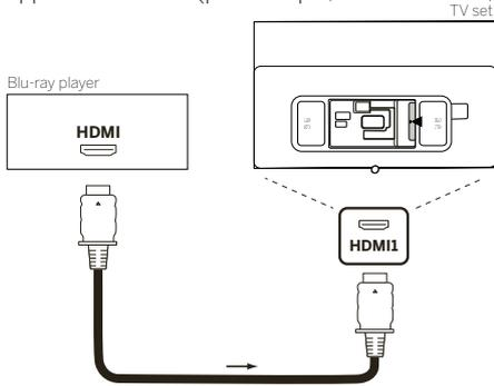
Connectez l'appareil à l'un des ports HDMI du téléviseur à l'aide d'un câble HDMI doté d'un connecteur de type A (non fourni). Pour profiter pleinement des fonctions de votre téléviseur, utilisez un câble portant la mention « Premium High-Speed HDMI Cable » ou supérieur.
