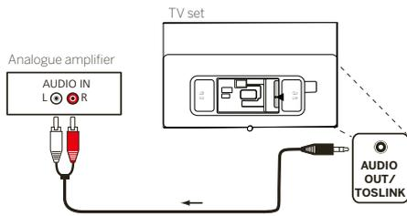
Collega l'uscita "AUDIO OUT TOSLINK" all'ingresso audio analogico del sistema audio utilizzando un cavo adattatore stereo RCA/Jack.
