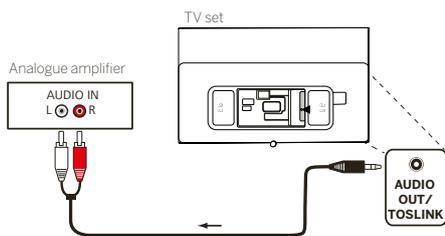
Reliez la sortie audio « AUDIO OUT TOSLINK » à l'entrée audio analogique du système audio à l'aide d'un câble adaptateur stéréo RCA/Jack.
