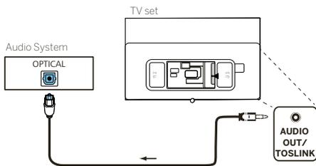
Reliez la sortie audio du téléviseur marquée « AUDIO OUT TOSLINK » à l'entrée audio numérique d'un système audio.
