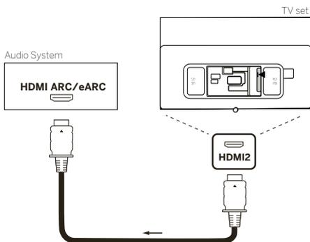
Utilisez un câble HDMI (non fourni) pour connecter la prise HDMI-eARC du téléviseur à la prise HDMI-ARC/eARC d'un système audio ou d'une barre de son. Nous recommandons d'utiliser un câble étiqueté « câble HDMI Ultra High Speed » avec une prise de type A.
