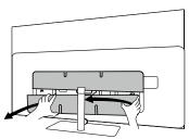
Wenn Sie ein externes Gerät mit diesen internen Anschlüssen verbinden, schließen Sie das Kabel zuerst an den Anschluss am Fernsehgerät an. Führen Sie das Kabel dann über das integrierte Kabelführungssystem aus dem Fernsehgerät heraus und führen Sie es dann durch den Hals des Standfußes (falls Sie die mitgelieferte Tischfußlösung verwenden).
