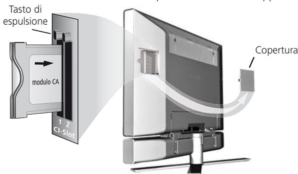
Inserire con attenzione il modulo CA nello CI-Slot 1 o 2 con il lato dei contatti rivolto in avanti.
