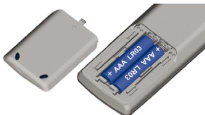
Pour la mise en place ou le remplacement des piles, appuyez sur la flèche. Faites glisser le couvercle du compartiment à piles vers le bas et retirez-le. Insérez des piles alcalines au manganèse de type LR 03 (AAA), veillez alors au bon positionnement du + et du -. Ensuite, remettez le couvercle en place en le poussant par le bas.
