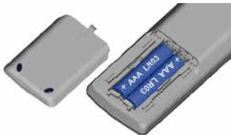
Pour la mise en place ou le remplacement des piles, appuyez à l'endroit de la flèche. Repoussez le couvercle du compartiment à piles vers le bas et retirez-le. Mettez en place des piles alcalines au manganèse de type LR 03 (AAA), veillez alors au bon positionnement du + et du -. Ensuite, remettez en place le couvercle en le poussant par le bas.
