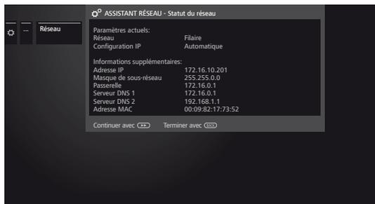
Sélectionnez le type de connexion à Internet de votre téléviseur : LAN (câblé) ou WLAN (sans fil). Ici vous pouvez voir le nom du réseau et l'adresse IP du téléviseur. Cette adresse, affichée dans l'application **Assist Media (Paramètres → Connecter)**, est destinée à différencier les différents appareils du réseau.
