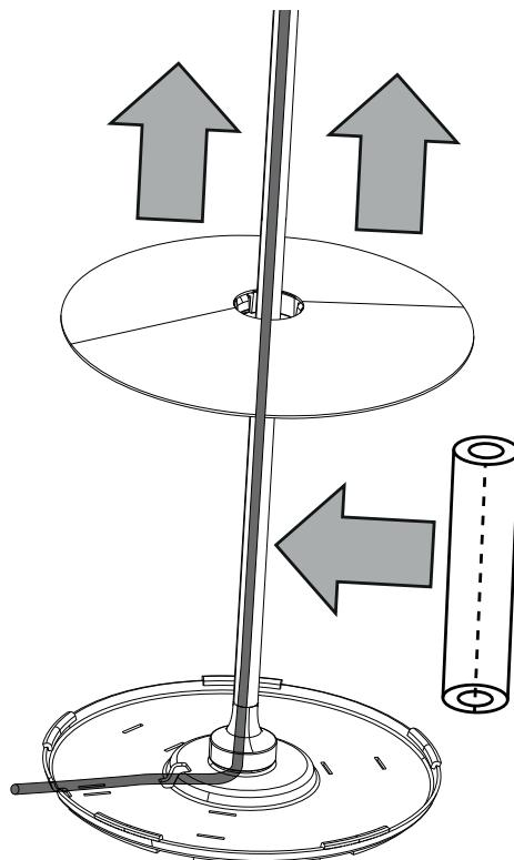
3. Verlegen Sie die Anschlusskabel im Standfuß des Loewe klang 5
