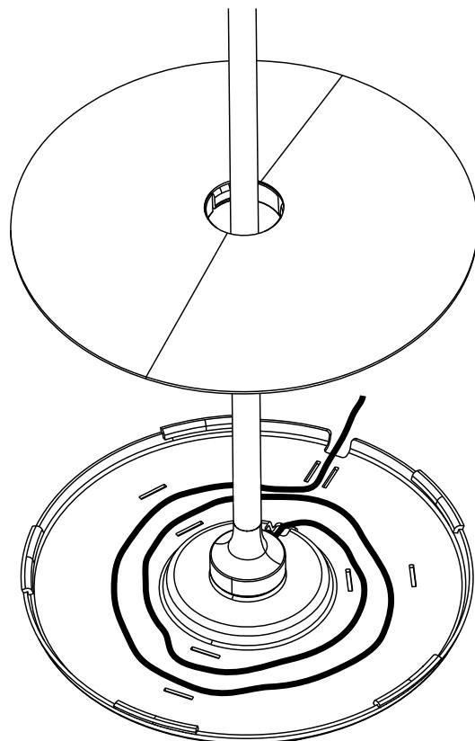
4. Entfernen Sie die Abstandshalterung aus Schaumstoff und befestigen Sie durch leichtes Drücken die Kabelabdeckung der Bodenplatte
