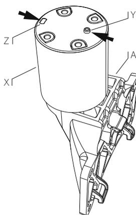
Kontrollieren Sie bitte, ob die zylindrische Abdeckung (X) der Rotation-Unit (A) in der richtigen Position aufgesteckt ist.
