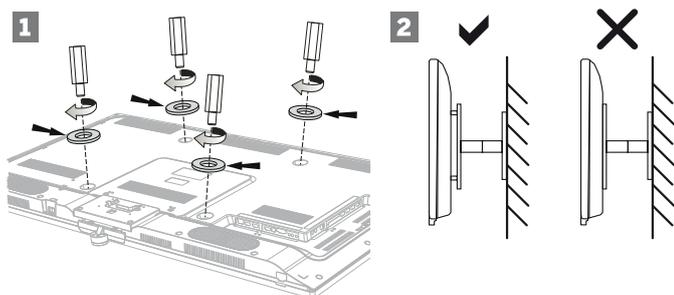
Die Loewe VESA-Adapterbolzen dienen dazu, die Stabilität und den Mindestabstand von 5mm zwischen Geräterückwand und VESA-Halter zu gewährleisten (siehe Abbildung 2). Der VESA-Halter darf keinesfalls auf der Geräterückwand aufliegen.
