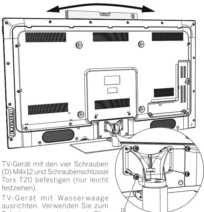
TV-Gerät mit den vier Schrauben (D) M4x12 und Schraubenschlüssel Torx T20 befestigen (nur leicht festziehen).
