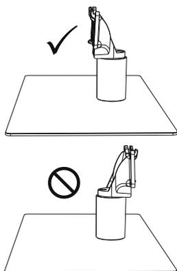
Setzen Sie die Rotation-Unit (A) auf die Table Stand Platte (B). Der Zapfen (Y) muss in die passende Bohrung der Platte gelangen.
