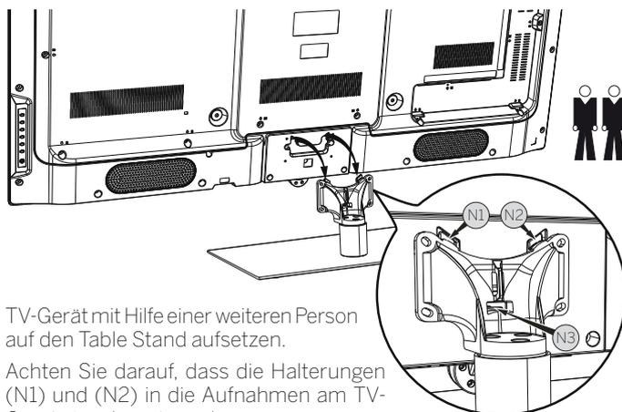
TV-Gerät mit Hilfe einer weiteren Person auf den Table Stand aufsetzen.
